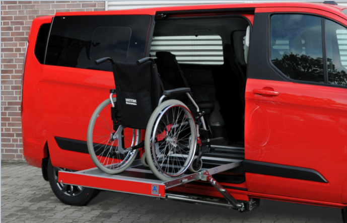
Die automatische Abrollsicherungsklappe und die großzügige Plattform sorgen für zusätzliche Sicherheit.
